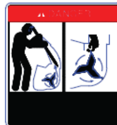
13. RDL3163 DANGER! ROTATING FAN
